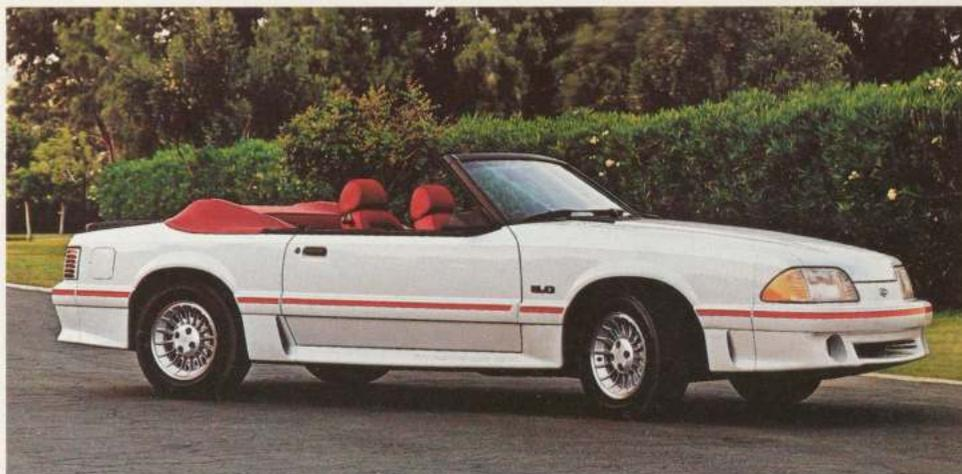
Ainsi, le nouveau capot surbaissé plus long, les boucliers avant et arrière, la jupe avant, les rallonges d'ailes intégrées avec prises d'air, le becquet arrière (monté sur couvercle de coffre) et les glaces latérales arrière affleurantes, contribuent à un meilleur écoulement de l'air et à une meilleure adhérence au sol.
