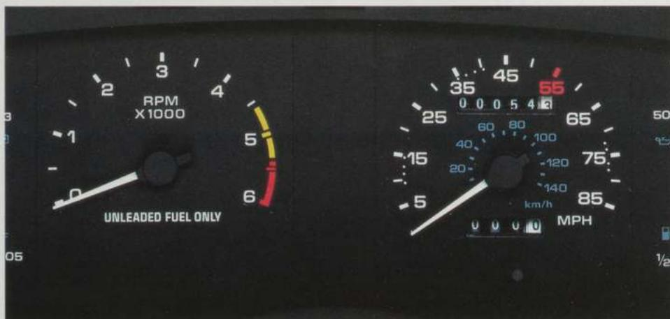
*Instruments analogiques de grandes dimensions éclairés par l'arrière pour une meilleure lisibilité en tout temps.*
