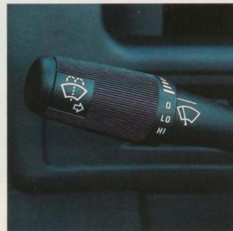
*Commandes des lave-glace/essuie-glace à balayage intermittent, des phares de route et de l'avertisseur optique de dépassement groupées sur un levier monté sur la colonne de direction pour être davantage à portée de la main.*
