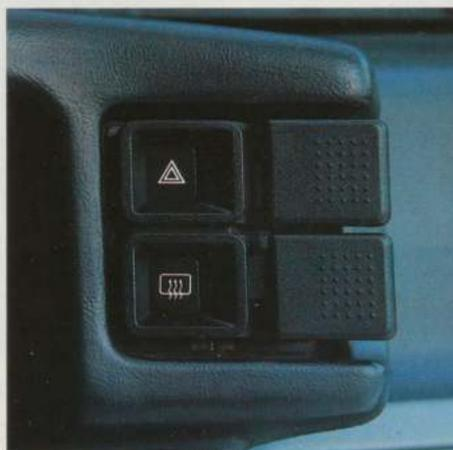
*Blocs de commande des phares, des clignotants de détresse et du dégivreur arrière facilement lisibles et aisément accessibles.*
