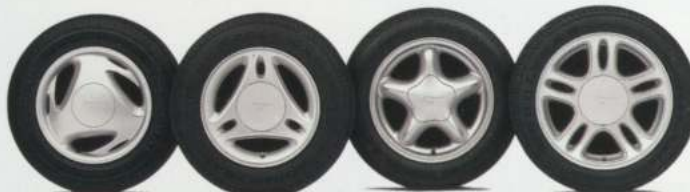
▲ De gauche à droite : enjoliveur de 15 po (de série sur Mustang); jante de 15 po en aluminium coulé (en option sur Mustang); jante de 16 po en aluminium coulé (de série sur Mustang GT); et jante de 17 po en aluminium coulé (en option sur Mustang GT).
