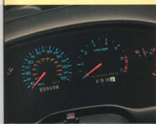
L'instrumentation analogique comprend : compte-tours, voltmètre, thermomètre d'eau, jauge de carburant et manomètre d'huile. Les instruments métriques sont de série au Canada.
