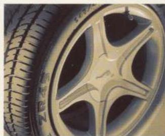
La tenue de route est améliorée par des jantes de 17 x 8 po en alliage d'aluminium forgé à cinq rayons avec pneus radiaux Goodyear P245/45ZR17 (en option pour la GT uniquement).
