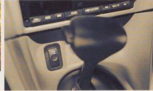
Situé commodément dans l'enjoliveur du sélecteur de vitesse, l'interrupteur d'antipatinage électronique en option facile d'accès permet d'améliorer l'adhérence.
