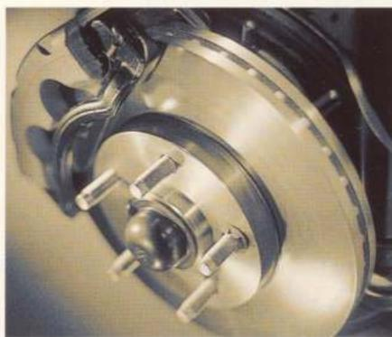
De nouveaux étriers de freins avant à double piston en aluminium aident à réduire le poids et à améliorer la sensation à la pédale. La modulation des freins est facilitée par la course allongée et plus linéaire de la pédale.
