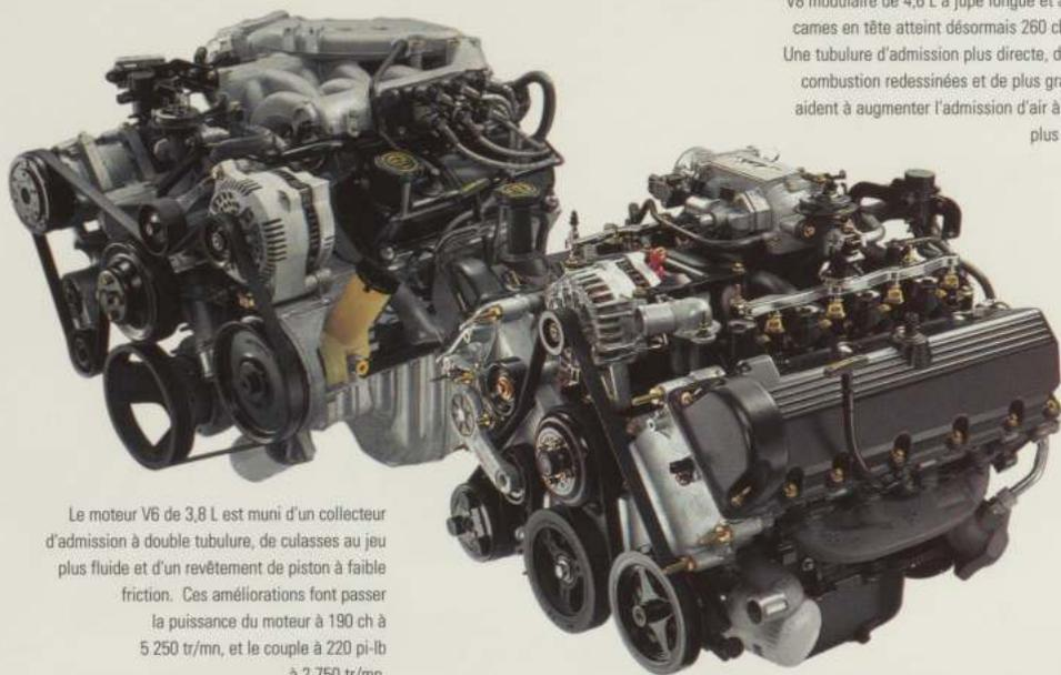
Le moteur V6 de 3,8 L est muni d'un collecteur d'admission à double tubulure, de culasses au jeu plus fluide et d'un revêtement de piston à faible friction. Ces améliorations font passer la puissance du moteur à 190 ch à 5 250 tr/min, et le couple à 220 pi-lb à 2 750 tr/min.
