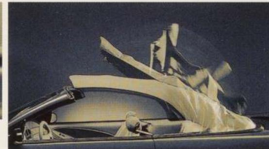
Le dispositif hydraulique de la capote du cabriolet est conçu pour ouvrir et fermer la capote 30 % plus rapidement qu'auparavant.
